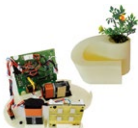
Vase connecté instrumenté pour l'évaluation non intrusive de la mobilité à domicile.
